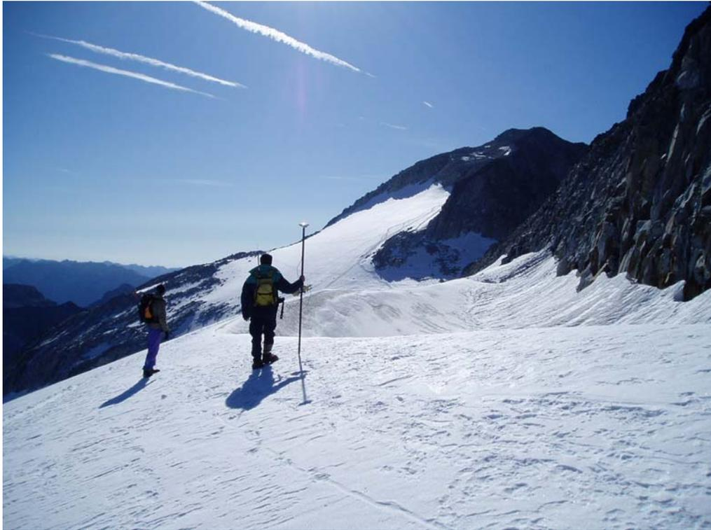
Medida de puntos de la superficie mediante GPS diferencial en la rimaya
