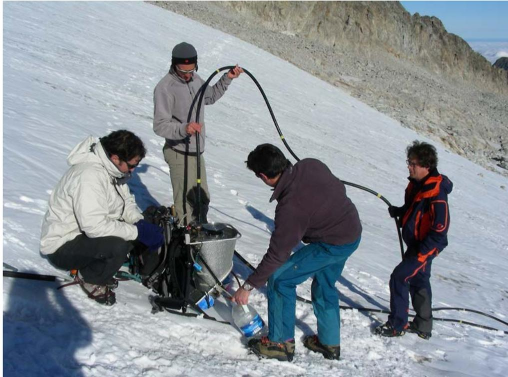
Medida in situ del espesor del glaciar mediante sondeo por sonda de vapor, para calibración del geo-radar
