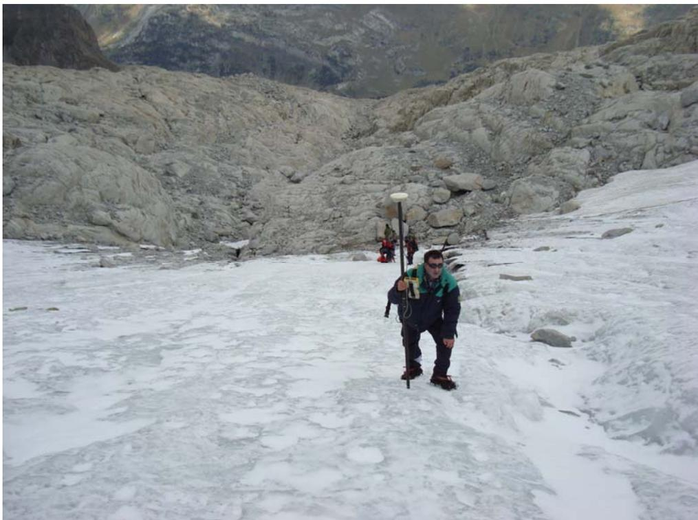
Parte baja del glaciar. Medida de puntos de la superficie mediante GPS diferencial
