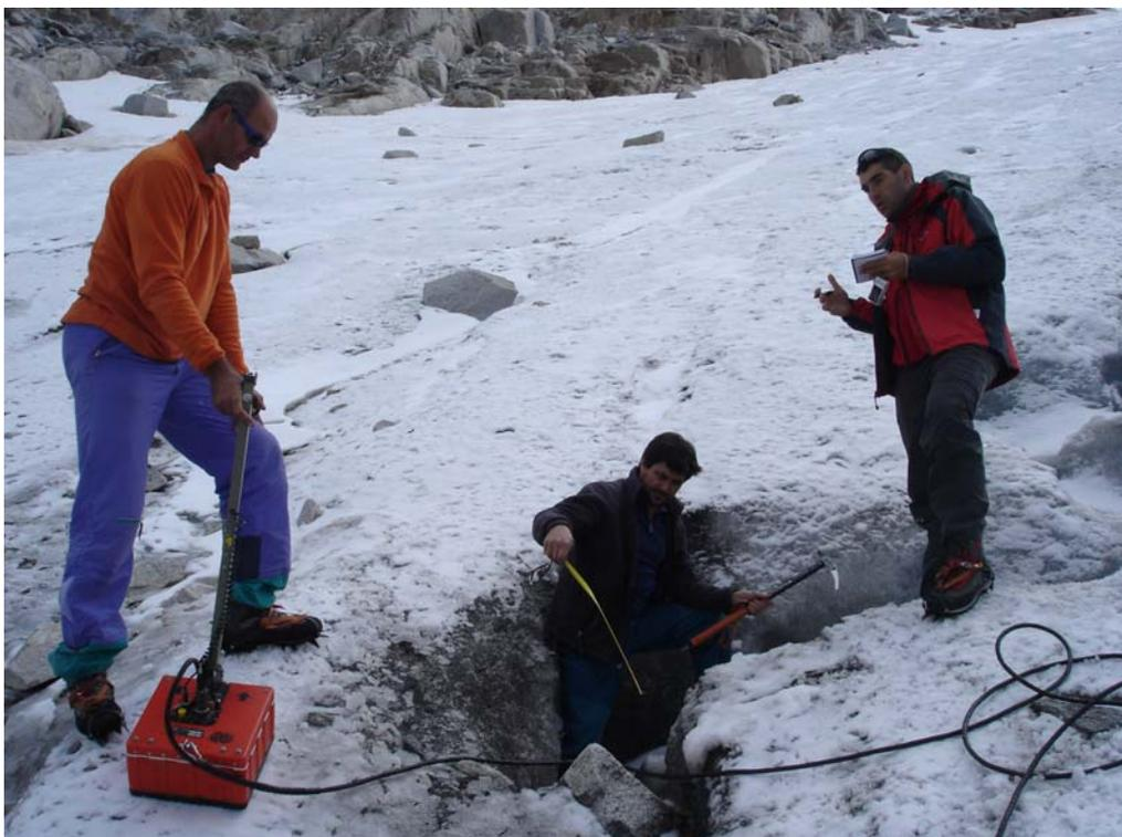
Medida in situ del espesor del glaciar en una grieta de la parte baja, para calibración del georadar
