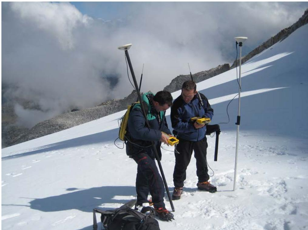
Parte superior del glaciar. Preparando los GPS diferenciales para la obtención de puntos de la superficie del glaciar y su contorno
